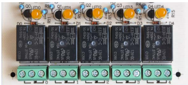
รูปรีเลย์และขั้วต่อเอาท์พุท 5 ตัว CON 0 - CON 4 จากทั้งหมด10ตัว
